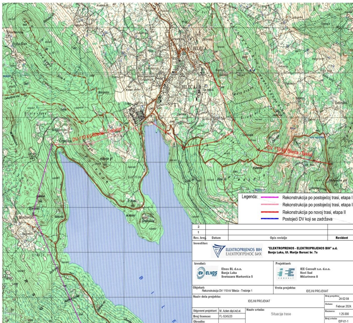
Slika 1. Trasa dalekovoda (na slici se vidi kompletna trasa dalekovoda 110 kV Bileća-Nikšić i dio trase dalekovoda 110 kV Bileća-Trebinje 1 do SM 22)
